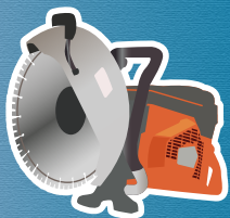
コンクリートカッター
